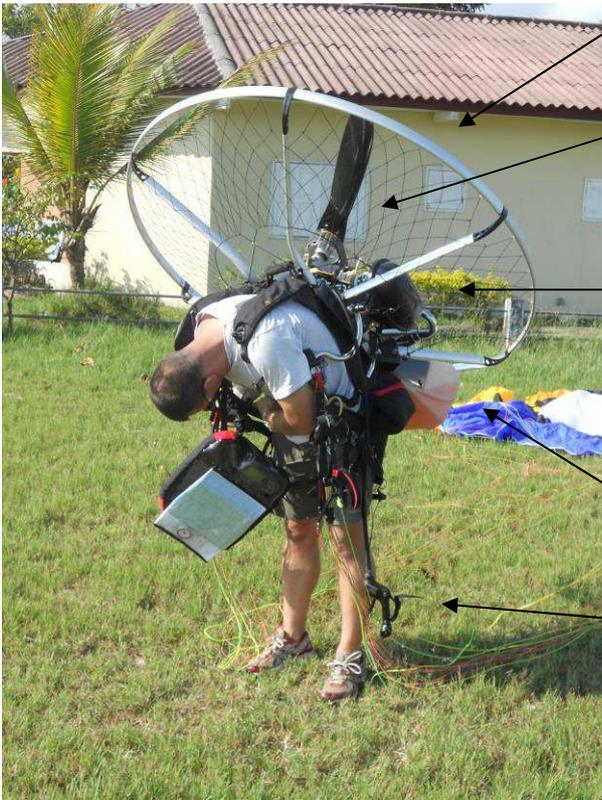
La cage de protection permet aux suspentes de glisser le long de celle-ci pendant la phase de décollage.
