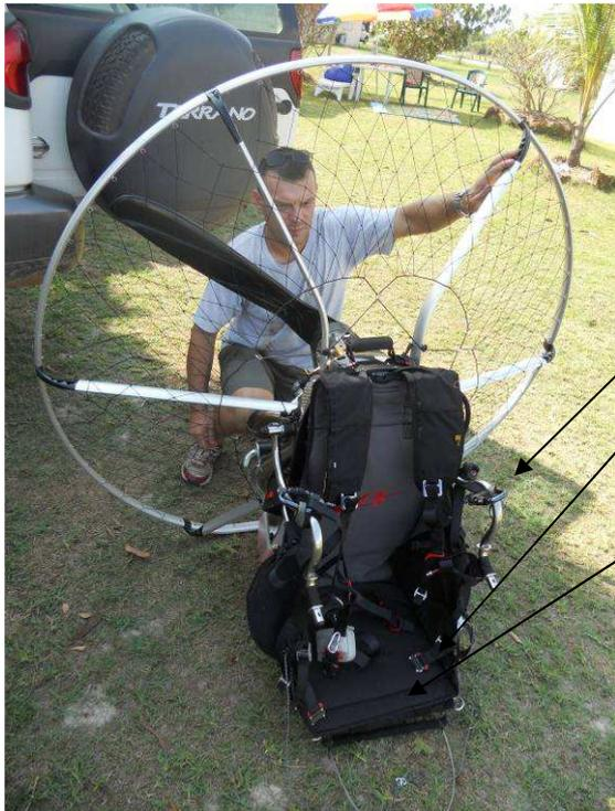
Les mousquetons permettent de fixer les élévateurs à la sellette.
